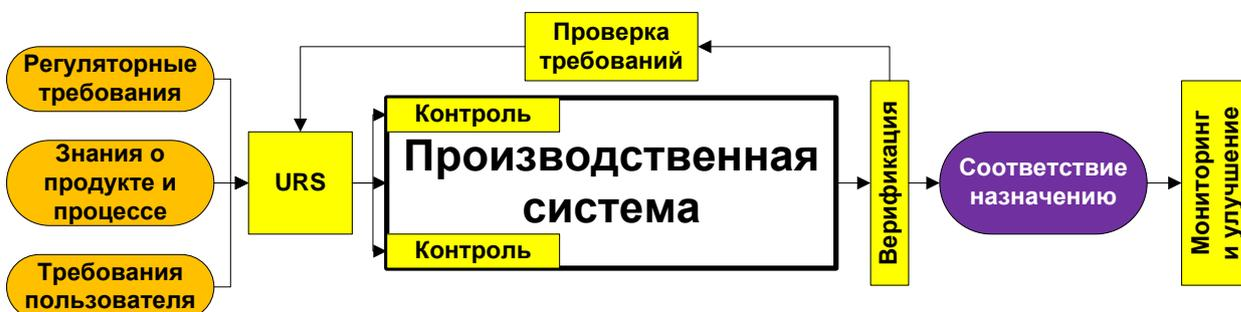
Рис. 6. Схема верификации производственной системы для подтверждения соответствия установленным требованиям.
